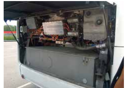
Kotimaisen sähköbussin "konehuone". Tuo harmaa iso laatikko on akku.
